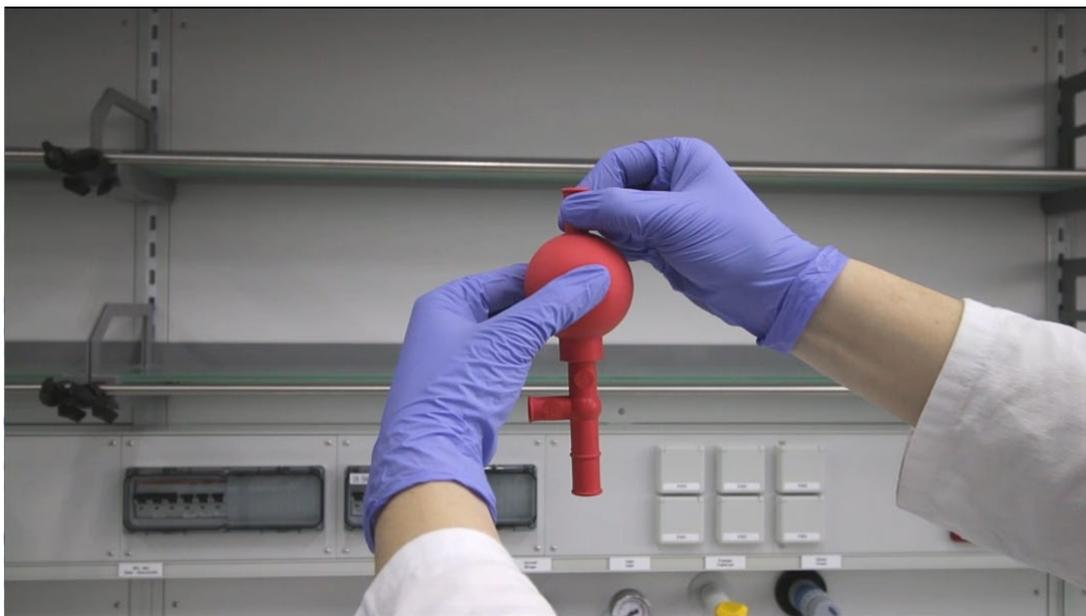
Abbildung 31: Bildausschnitt aus dem Video „Umgang mit Glaspipetten“, Erläuterung eines Peleusballs.
