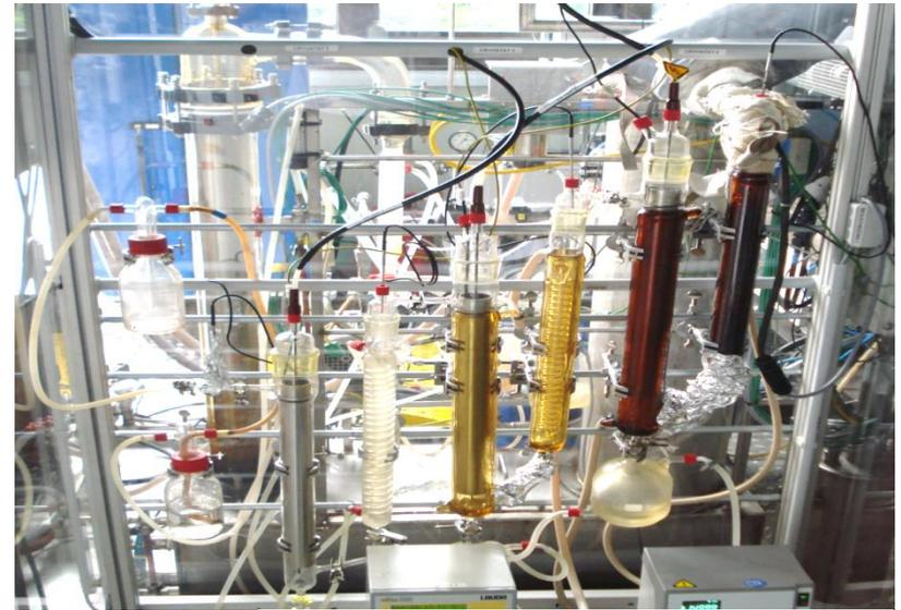
**Bild:** gestufte Kondensation Fraunhofer UMSICHT
